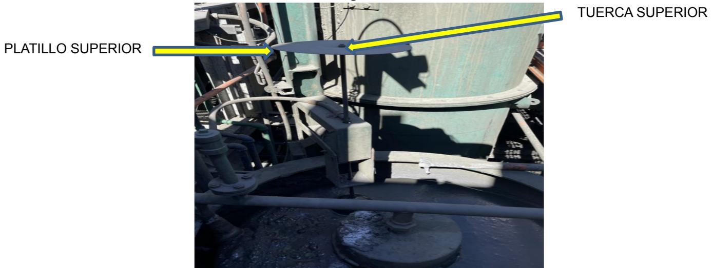
Realizado el paso anterior se procede a retirar pasadores del flotador deslizando hacía el interior de la celda amarrado con un cordel hasta que salga del fin de carrera, según figura N° 2
